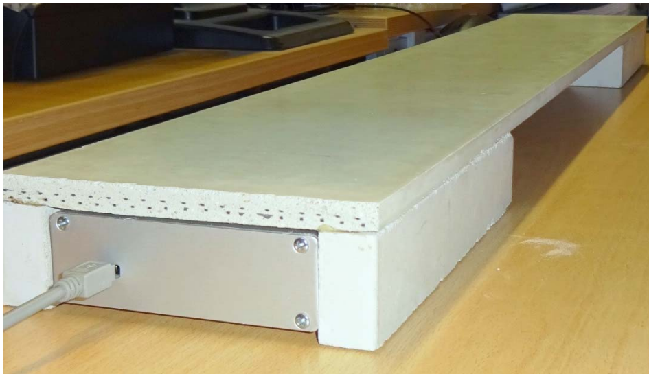
Leichter messen: Künftige Bauwerke wie Brücken aus Carbonbeton sollen von sich aus Auskunft über ihren Zustand geben / Quelle: ITM
